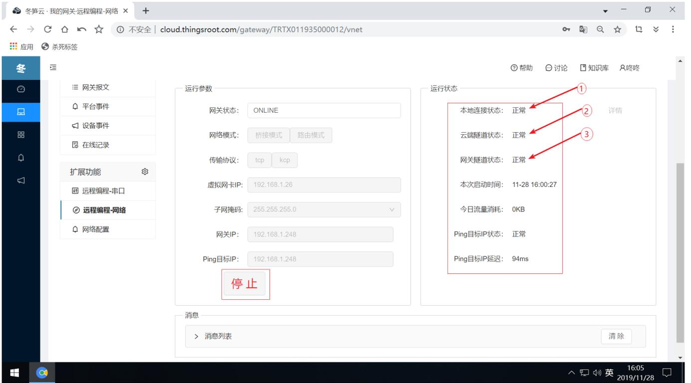
8. 接下来，可以试一试和实际的现场设备是否联通，使用设备的编程软件是否能连接设备并操作。这里举例使用西门子的S7-200-Smart编程软件STEP 7-MicroWIN SMART和远程PLC通讯来测试是否通畅。在STEP 7-MicroWIN SMART中通信接口选择TAP-Windows Adapter V9的网卡，然后点击“查找CPU”按钮，几秒后，就找到远程的PLC了，PLC目前的地址是192.168.2.1，和本地虚拟网卡的IP地址不在一个网段，如点击连接STEP 7-200-Smart编程软件或给本地的虚拟网卡增加一个192.168.2.xxx的IP地址。接下来，就是正常的PLC编程操作了。
