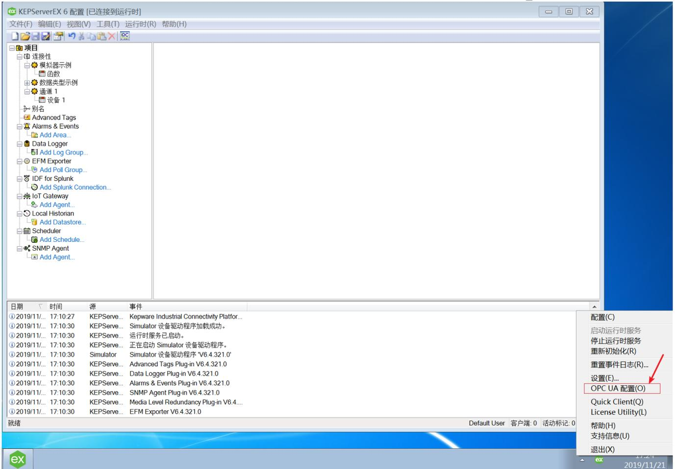
在“OPC UA Configuration Manager”界面中配置全局的OPC UA参数，如不修改配置，那么OPC UA Server服务只运行在本地的环回网络中，无法对网络上其他计算机提供数据服务。在服务器端点TAB页面中修改UA Server的配置。既可修改当前默认的配置将OPC UA Server服务绑定到本地的任意IP地址，也可通过添加按钮增加一个新的配置将OPC UA Server服务绑定到本地的指定网卡上。
