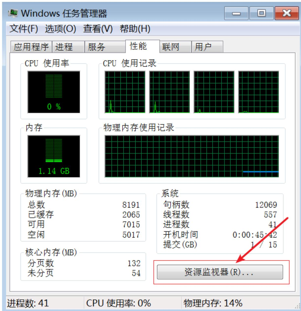
2) 启动资源管理器后，切换到网络TAB页面，展开界面中的侦听端口，端口排序后，找到KEPServerEX的OPC UA Server对外提供服务的49320端口，检查目前的状态，看看进程是否是KEPServerEX的“server\_runtime.exe”地址是否是“未指定 IPv4”端口49320是否存在，防火墙状态是否为“允许，不受限制”，如果这几项任一项不符合刚刚说的条件，那么在网络中就无法访问KEPServerEX的OPC UA Server服务。
