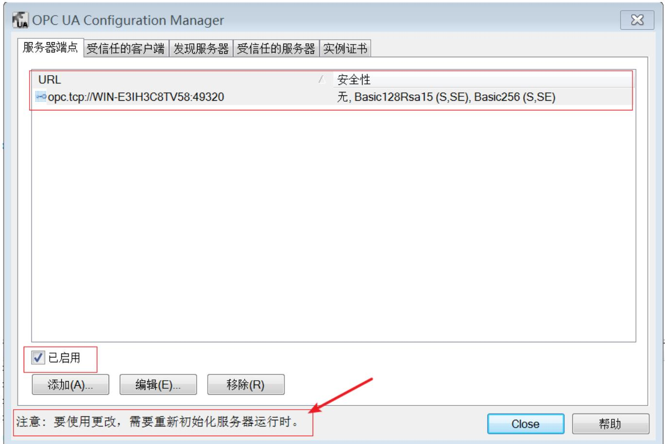
完成以上配置并对KEPServerEX进行重新初始化，配置虽然生效，但网络上的OPC UA Client可能还是无法连接KEPServerEX的OPC UA Server，还需继续下面的配置
