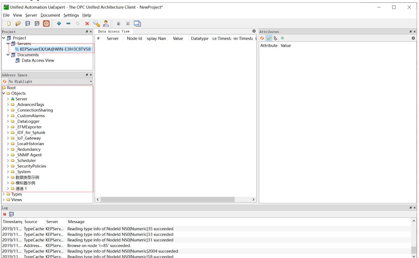
7) 展开KEPServerEX UA Server的各层节点，将需要监视的测点拖拽到右侧的“Data Access View”窗口。就能看到数据变化了。
