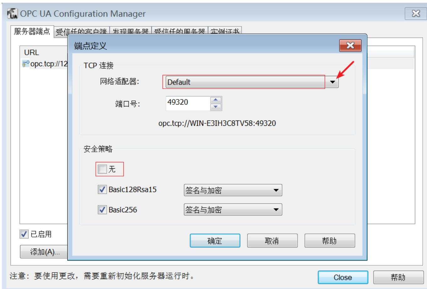
配置完成后，修改后的配置如下，如要使修改立即生效，需要重启KEPServerEX的后台服务，或通过托盘栏图标对KEPServerEX进行重新初始化。
