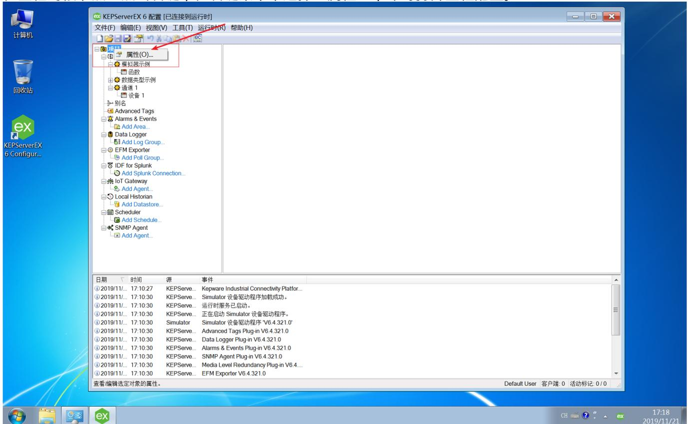
在工程属性编辑器界面中，在属性组下选择OPC UA，检查右侧窗口中的参数，默认工程开启了OPC UAServer服务，不允许匿名登录，可以修改为匿名登录，这样在使用OPC UA Client测试减少一些步骤。
