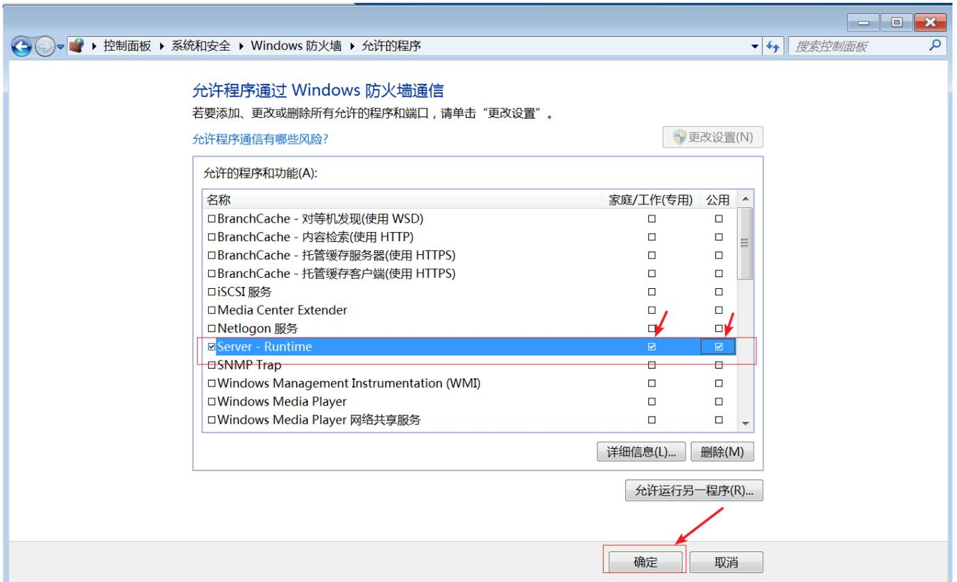
7) 修改配置后，记得将KEPServerEX后台服务重启或将KEPServerEX重新初始化。再次在资源监视器中检查KEPServerEX的后台进程“server\_runtime.exe”是否运行，地址是否是“未指定 IPv4”端口49320是否存在，防火墙状态是否为“允许，不受限制”。
