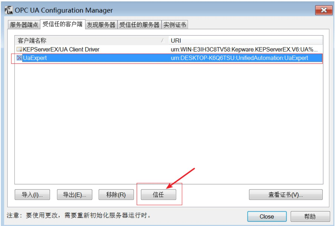
6) 再次在UaExpert中点击连接图标即可连接 KEPServerEX UA Server[]终于可以连接上KEPServerEX UA Server了。
